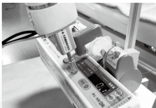
ロボットのアーム先端が、シリンジポンプの早送りボタンに接触
