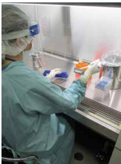
COVID-19臨床検体の取り扱いはBSL2+実験室で実施します。前室でPPE(個人防護具)を身に着け、検体はBSL2+実験室の安全キャビネット内で取り扱います
